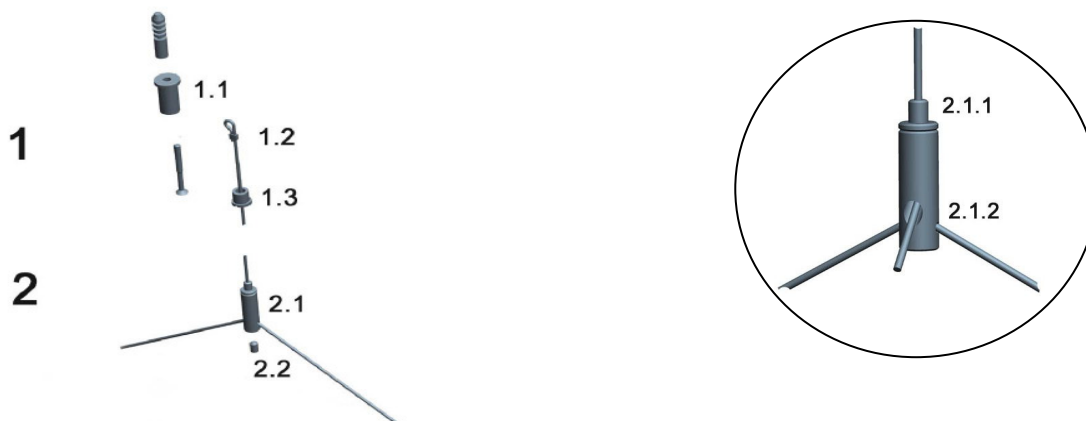
Рис. 2: Подвес из стальных тросиков, aquafit 3
