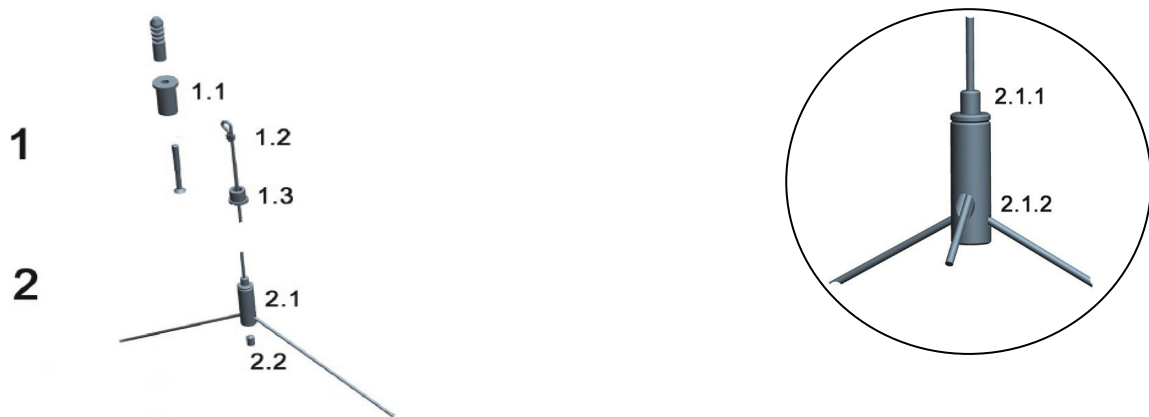
Foto 2: Suspensión en cable de acero, aquafit 3 (Art.-No. 80402)
